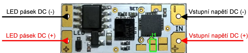
Obr. 1 - Zapojení vývodů modulu
